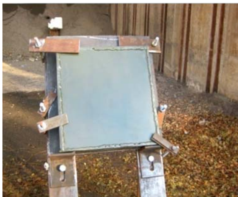
Fig. 2.2. Varianta III propusă pentru blindajul suplimentar la tancul TR-85 M1/
