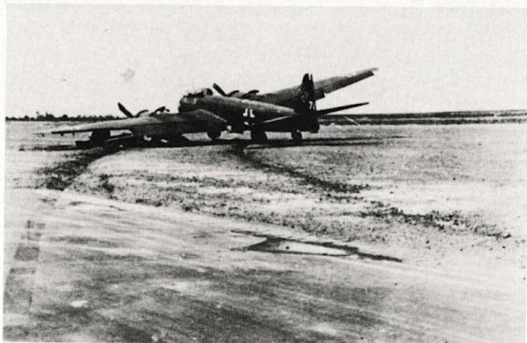
Bild 57: ... Trägerflugzeug wurde bei der Landung wegen der einseitigen Belastung der linken Tragfläche beschädigt ...
