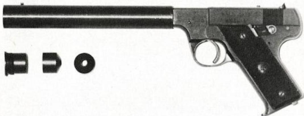
Bild 27: Wie Bild 26, Vorderkappe abgeschraubt, Hülse und Scheibe herausgenommen.
