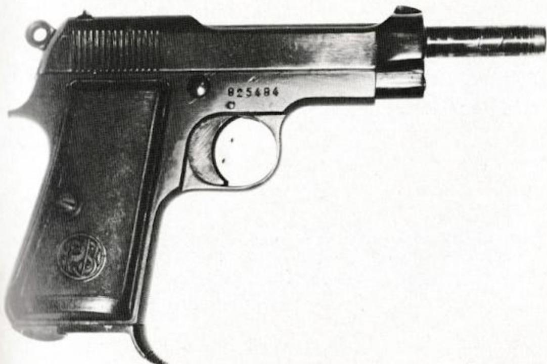
Bild 30: Pistole Beretta Mod. 34 mit langem Lauf für Schalldämpfer.
