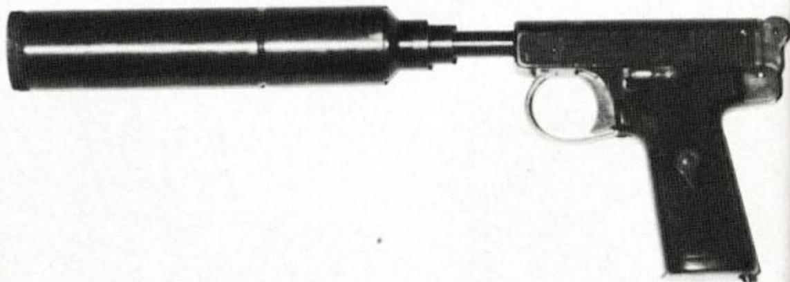
Bild 21: Pistole Webley & Scott mit Schalldämpfer wie auf den Bildern 18 bis 20.
