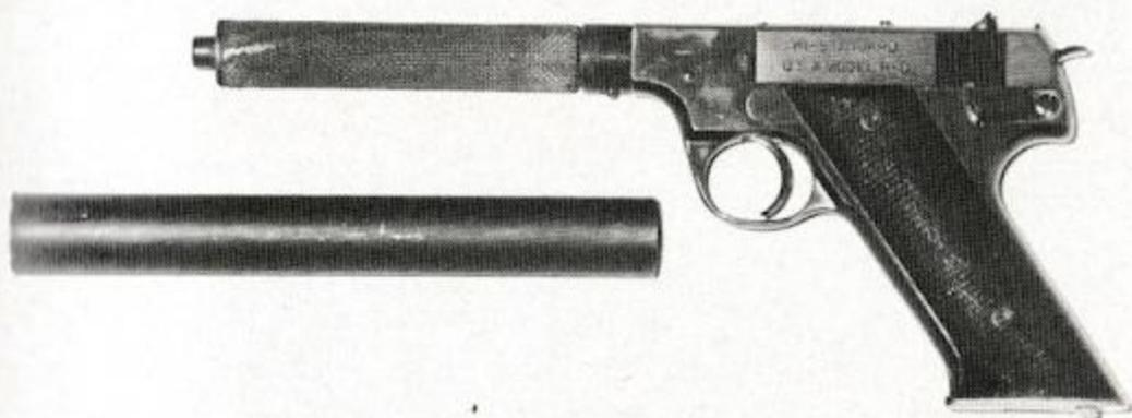
Bild 26: Wie Bild 25, Dämpfergehäuse abgenommen.
