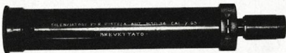
Bild 31: Beretta-Schalldämpfer für Pistole von Bild 30, Blick auf die Beschriftung und die Visiereinrichtung von oben.
