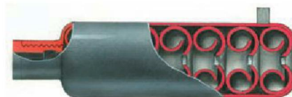
Глушитель с шайбами - завихрителями потока из американского патента 1909 года Хайрема Перси Максима
