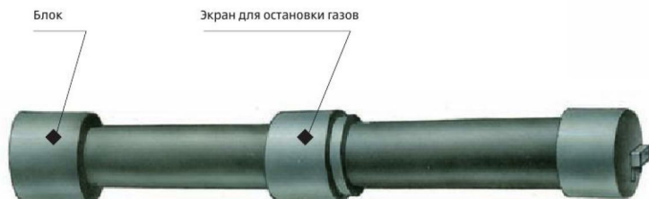
Пулемёт Максима с звукоглушителем
