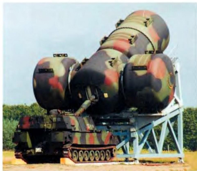
Бывают и такие «глушители»... Устройство подавления звука выстрела для 155-мм гаубицы на западногерманском полигоне (чтобы не беспокоить канонадой население окрестных деревень)
