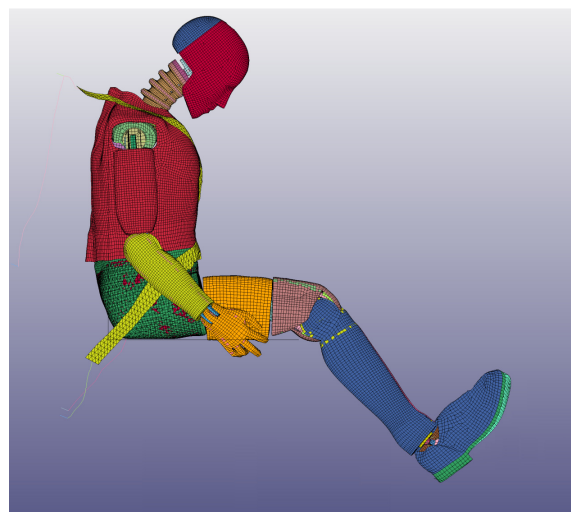
Fig. IV.1.25 Manechinul în faza de urcare pentru simularea de nivel 2b
