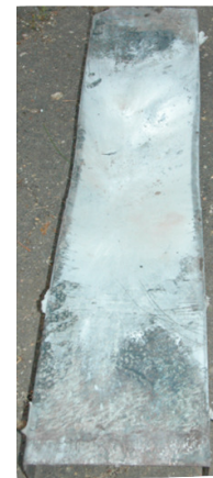
Figura IV.3.8 Efectele exploziei asupra plăcilor cu poliuree depusă pe partea frontală
