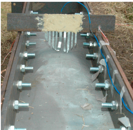
Figura IV.3.6 Efectele exploziei asupra plăcii de referință
