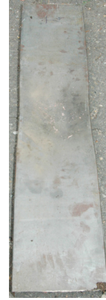
Figura IV.3.7 Efectele exploziei asupra plăcilor cu poliuree depusă pe partea dorsală S2-1
