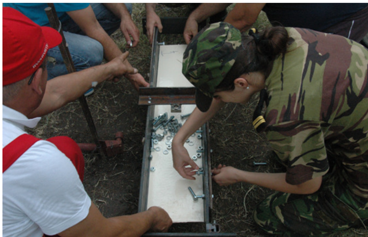
Figura IV.3.3 Montarea plăcilor studiate în suportul de testare
