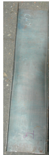
Figura IV.3.8 Efectele exploziei asupra plăcilor cu poliuree depusă pe partea frontală
