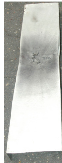
Figura IV.3.8 Efectele exploziei asupra plăcilor cu poliuree depusă pe partea frontală
