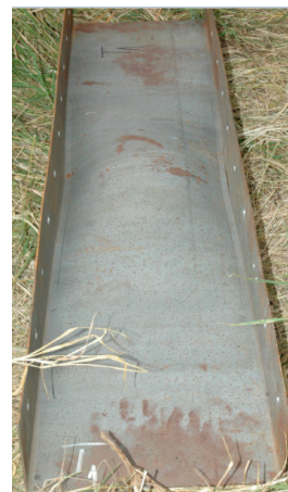
Figura IV.3.6 Efectele exploziei asupra plăcii de referință
