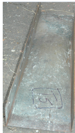
Figura IV.3.8 Efectele exploziei asupra plăcilor cu poliuree depusă pe partea frontală
