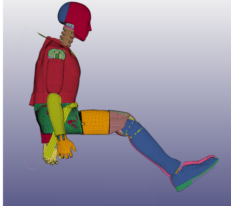
Fig. IV.1.26 Manechinul în faza de coborâre pentru simularea de nivel 2b
