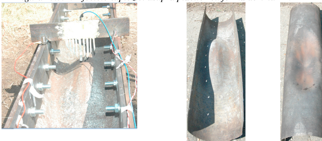
Figura IV.3.11 Efectele exploziei asupra plăcii cu formă semi-eliptică
