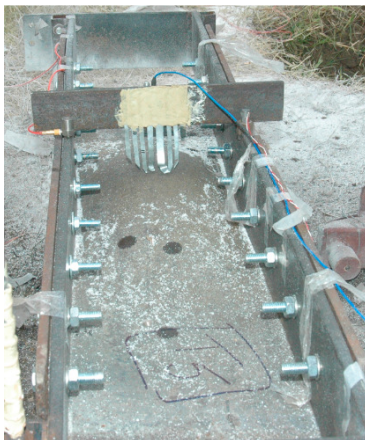
Figura IV.9 Efectele exploziei asupra plăcilor bistrat oțel-perlit
