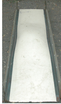
Figura IV.3.7 Efectele exploziei asupra plăcilor cu poliuree depusă pe partea dorsală S2-1
