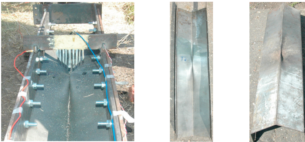
Figura IV.3.10 Efectele exploziei asupra plăcilor cu formă de V la 120°
