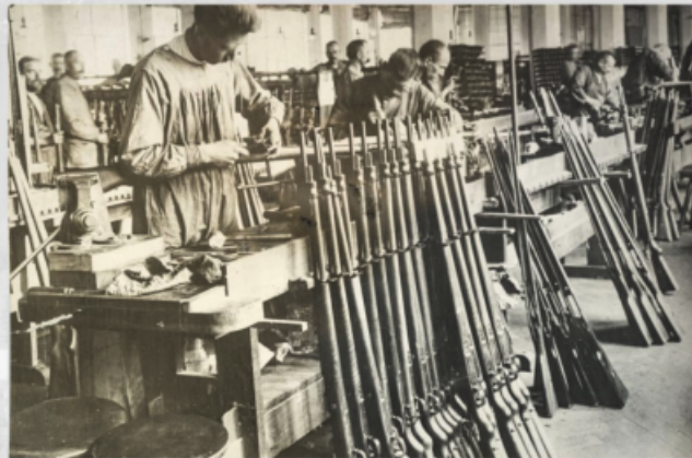
IN EINER RÜSTUNGSWERKSTATT montieren Arbeiter das Gewehr 98. Dabei muss jedes Bauteil millimetergenau passen. So entsteht zwischen Schraubstock und Ölkännchen die damalige Standardwaffe des deutschen Heeres.
